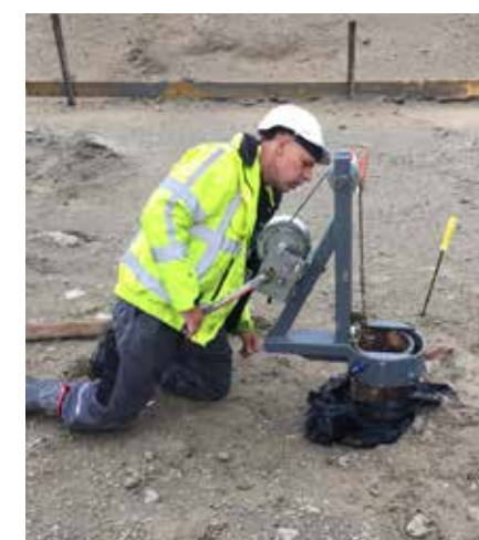
Het creëren van de liners door BodemBouw ten behoeve van de kwaliteitswaarborging. Met behulp van de liners worden monsters uit het volledige paneel genomen en uitvoerig in een laboratorium getest.
